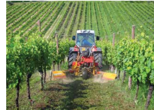
Trinciapacciamatrice al lavoro su un vigneto a ritocchino completamente inerbito; la macchina riesce ad effettuare una buona pulizia meccanica delle infestanti sotto la fila ; si evitano così, là dove è possibile, il diserbo chimico e le lavorazioni lungo fila che possono favorire l'erosione del terreno.
